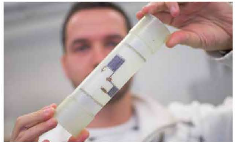
Michael Heinrich von Fiber Check zeigt den gestickten Dehnungssensor, für den ein Metallfaden in ein Vlies und dann in ein Glasfaserbauteil eingearbeitet wird. Dieses System erkennt Schäden in Rotorblättern schon bei der Entstehung. Ein weiterer Vorteil: Der Blattzustand ist über USB, Ethernet, Mobilfunk und ISM-Band jederzeit und überall abrufbar. Foto: TU Chemnitz
